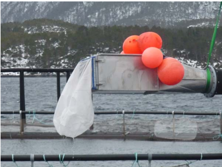
Figur 4: Pumpesystemets utløpskasse skal holdes flytende ved bruk av blåser. Filterposen for oppsamling av avspylt lus sees til venstre i bildet. Fisken kommer ut i overkant av kassen, se Figur 6 (Foto: Ulf Erikson)
