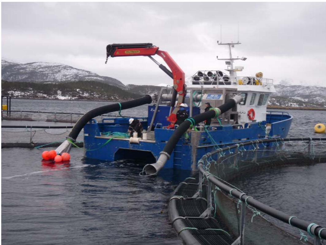
Figur 2: Ejetorpumpe for flytting og avlusing av fisk. I denne undersøkelsen ble laks til avlusing pumpet fra merden til høyre over i merden til venstre i bildet (Foto: Ulf Erikson)
